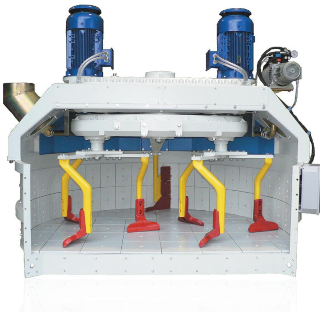
**1 DESCONFIE** de quem oferece misturador indicando a sua produção horária, pois um misturador depende de sistemas de carregamento externos que o abastecem com os materiais a serem misturados, e que variam a cada caso. O correto é especificar o tempo para produzir um concreto convencional homogêneo. O tempo de ciclo de um misturador CIBI está entre 40 e 60 segundos.
